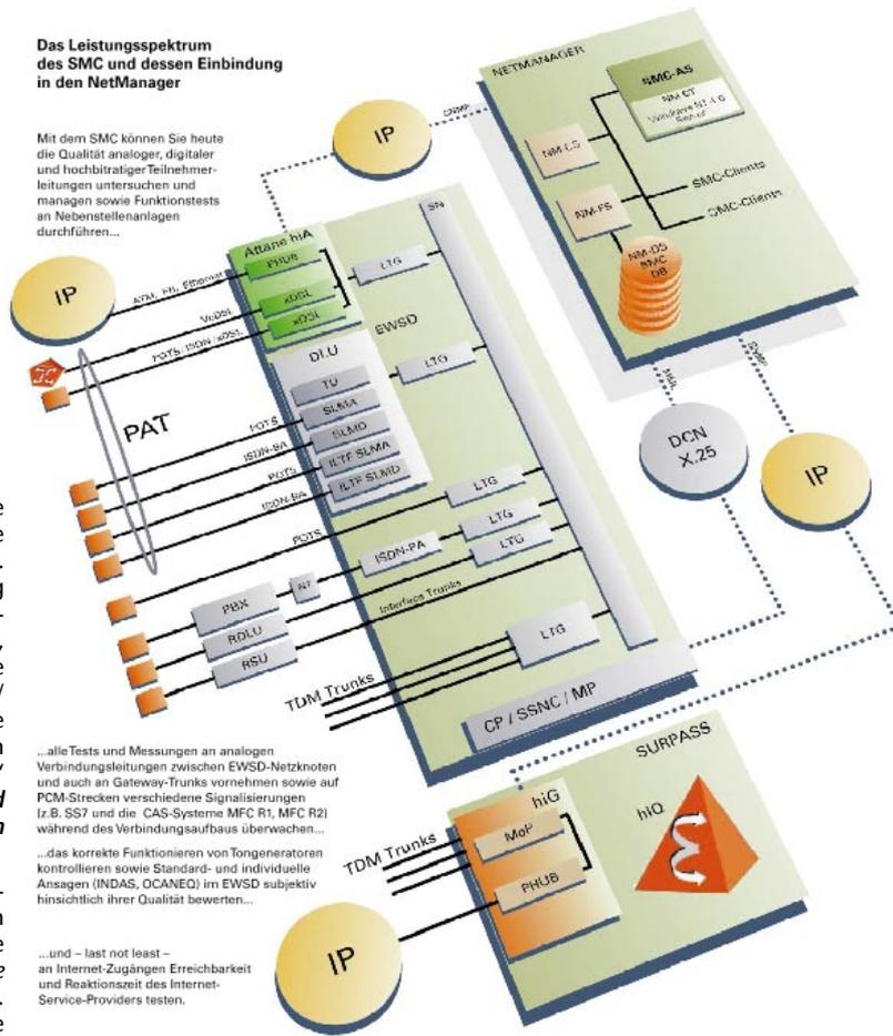
...alle Tests und Messungen an analogen Verbindungsleitungen zwischen EWSD-Netznoten und auch an Gateway-Trunks vornehmen sowie auf PCM-Strecken verschiedene Signalisierungen (z.B. SS7 und die CAS-Systeme MFC R1, MFC R2) während des Verbindungsaufbaus überwachen...
